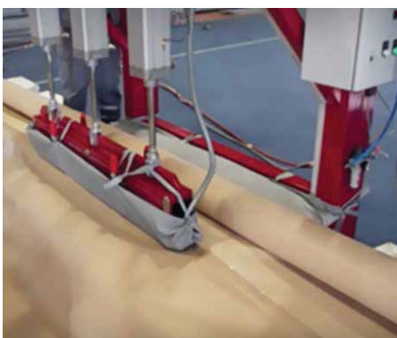
⑦ Hot bar press welding
